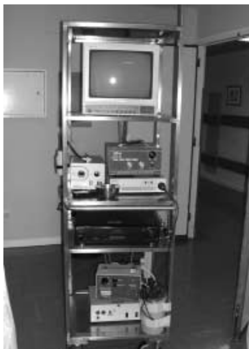
FIGURA 11. Torre de transporte de los accesorios necesarios para realizar una endoscopia respiratoria fuera de la sala de endoscopia. Nótese que salvo el propio broncoscopio, la torre incluye el resto del material necesario: monitor, fuente de luz, video, etc.
