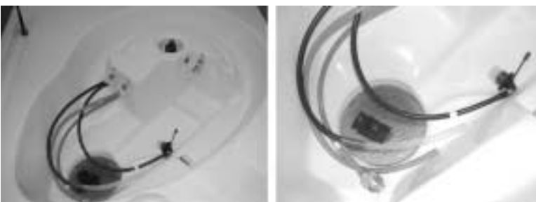
FIGURA 6. Detalle de las conexiones del interior de las máquinas de limpieza automática. Obsérvese las diversas conexiones a la solución desinfectante, de limpieza, agua estéril, etc.
